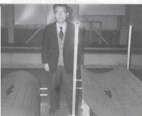
凹凸面上の水流特に中央に柱体を立て、周囲の渦を可視化する装置
