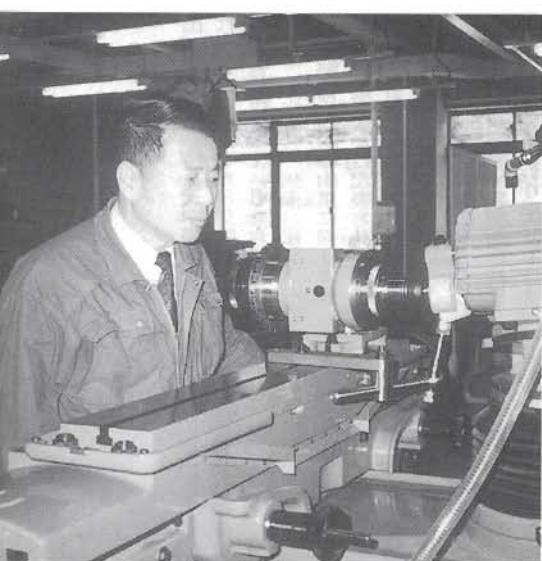
万能工具研削盤でエンドミルの研削中
