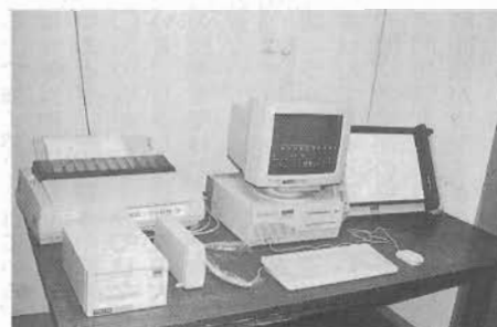
写真2 光磁気ディスク・データ解析システム 手前左の光磁気ディスクに保存したデータの解析を行うことができる。
