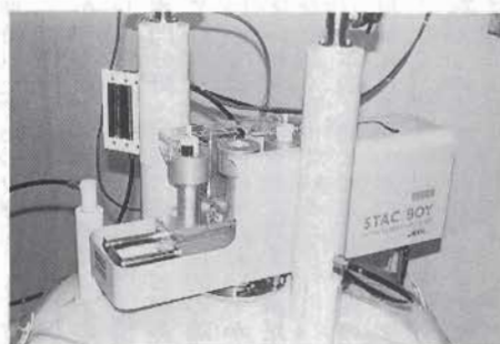
写真1 オートサンプラー 三本の試料について無人でデータ収集できる。
