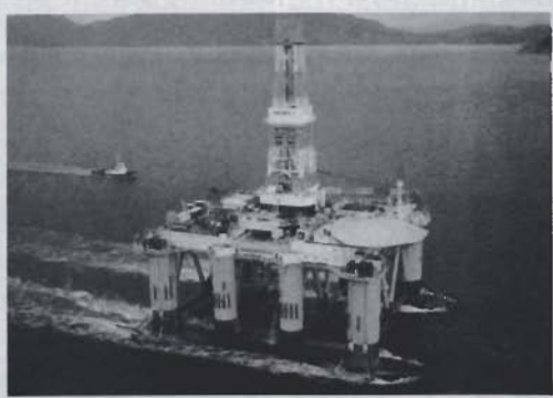
写真1 海底油田開発のための半潜水式掘削ユニット (三菱重工株式会社提供)
